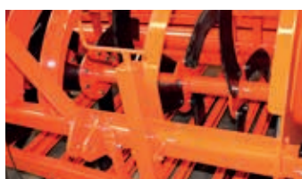
Lames aératrices fixées avec des boulons de cisaillement
