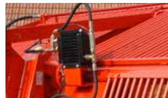
Optional: Ölkühler zum Kühlen des Öls im Getriebegehäuse
