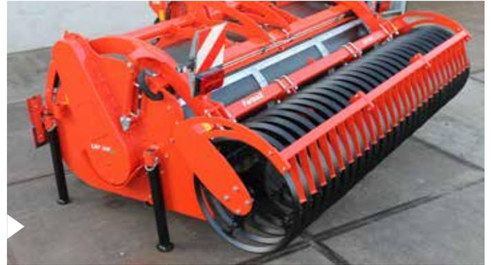
Die Spatenmaschine kann standardmäßig mit einer angetriebenen Kreiselegge, einer angetriebenen Fräse oder einer synchronisierten Packerwalze ausgestattet werden. Auf diese Weise schafft die LRP Profi eine optimale Fläche für die Aussaat oder Bepflanzung auf allen Bodenarten! Darüber hinaus kann die LRP Profi mithilfe angebrachter Befestigungspunkte oder einem Aufbauhilt mit einer Sämaschine kombiniert werden.
