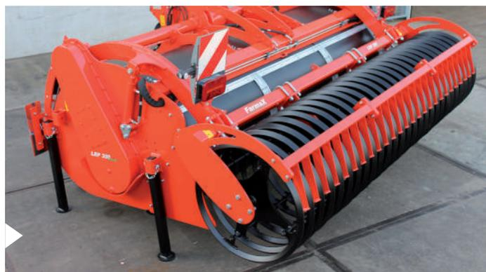
Cette machine à bêcher peut être équipée en standard d'une herse rotative entraînée, d'un rotoculteur entraîné ou d'un rouleau packer synchronisé. Ainsi, le LRP Profı crée le lit optimal pour semer ou planter dans tout type de sols ! En outre, le LRP Profı peut être combiné à une machine à semer avec des points d'attache fixes ou un élévateur monté sur le dessus.
