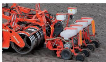
Semoir dans élévateur monté sur le dessus
