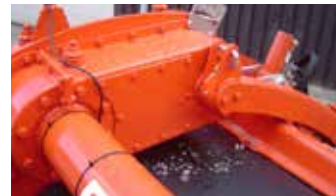
Zwischenantrieb für schmale Transportbreite
