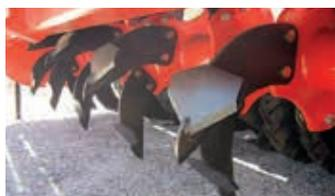
Les lames à bêcher sont fixées avec des boulons à cisaillement
