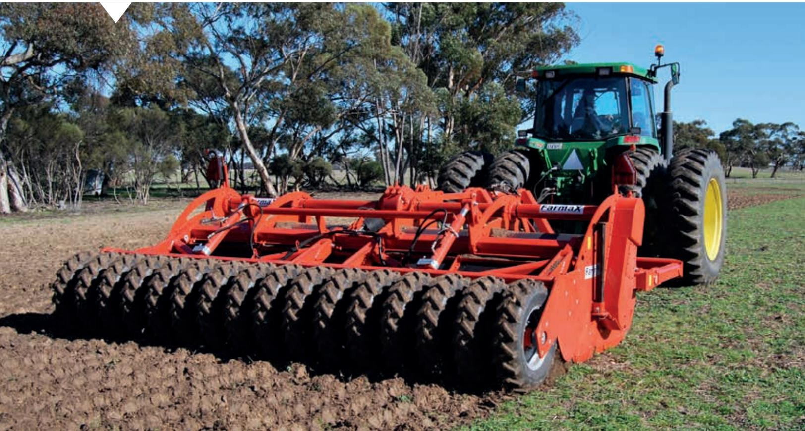
**Le Rapide Trailed de Farmax est une machine à bêcher remorquée avec une largeur de travail à partir de 4,5 mètres.**
