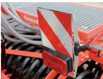
Ausgestattet mit LED-Beleuchtung
