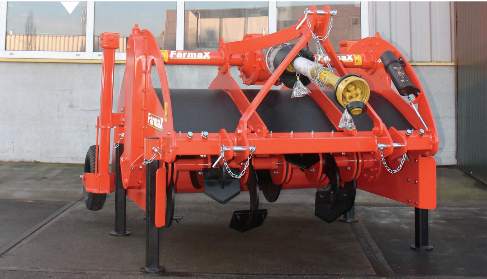
**La machine Farmax SRP-F est une bêcheuse compacte pour réaliser des lits de semence, adaptée par excellence à l'usage dans les vastes champs des cultures maraîchères de pleine terre et sous serre, dont la puissance nécessaire s'élève à 55 pk au minimum.**
