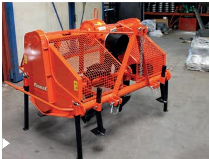
**Drive to main axle (rotor):** Transmission à roues dentées sur les deux côtés de la machine. L'entraînement est réalisé par la boîte de transmission avec son différentiel.
