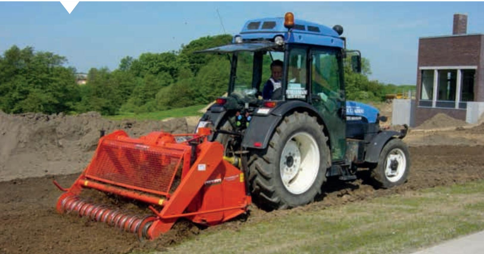
**Lits de plantation parfaits avec la machine à bêcher SRP de Farmax. La machine à bêcher SRP de Farmax est spécialement conçue pour les cultures d'arbres, de fruits et de légumes.**
